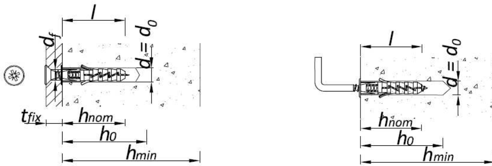
Rys. 17. Parametry montażowe łączników rozporowych FIX
